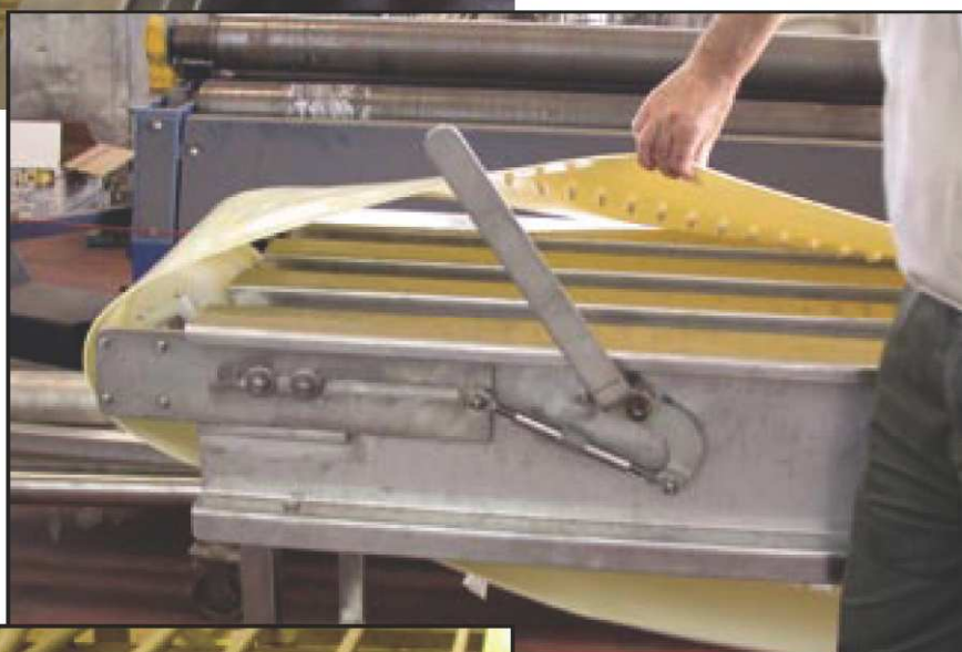
Profily z UHMW jako kluzné lože pásu. Poznámka: oba středové profily jsou posunuty blíže k sobě pro správné vedení zubů pásu SuperDrive.
