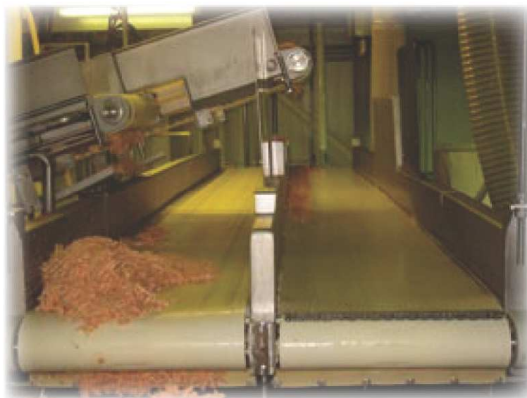
Dopravník na dopravu rozemletého drůbežího masa. Dopravník vpravo má mechanickou sponu.
