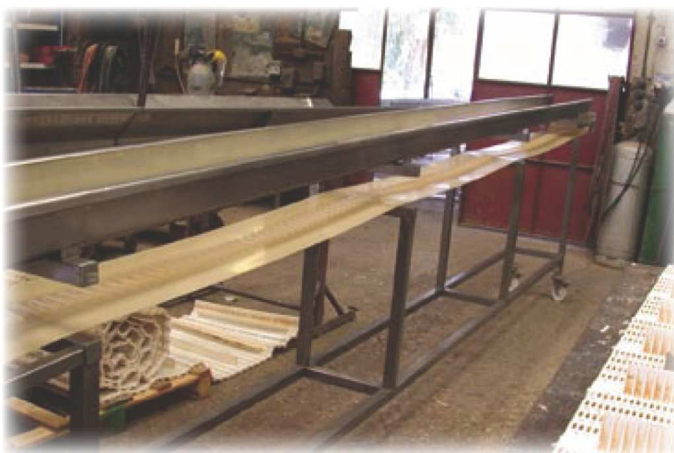
Konstrukce dopravníku dovolující celkové vyjmutí pásu
