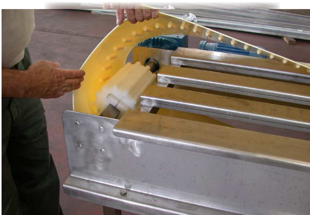
Pohled na hnací kolo a nerezové lože dopravníku s drážkou pro zuby pásu SuperDrive.
