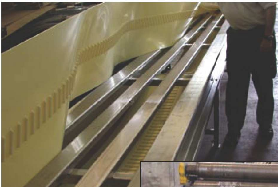
Nerezové kluzné lože konstruované s vodící drážkou pro zuby pásu SuperDrive
