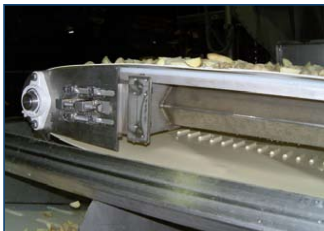
FHW-3 SD – Funkce integrovaných zubů jako vedení pásu
