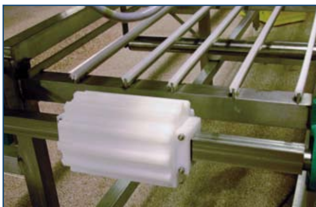
Obrázek 5: Hnací kolo SuperDrive™ s typickou čtvercovou hřídelí
